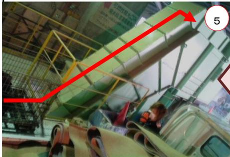
5 次に細くなったゴミが左図にある機械内部のベルトコンベアに乗って矢印の方向へ進んでいきます。
