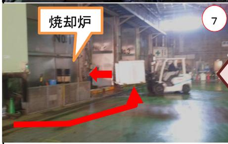
7 そして最後は、ボックスにたまったゴミを、焼却炉に入れて、後に燃やす、、、という手順で処理します。
