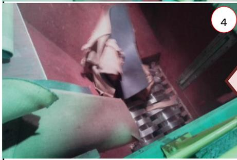
4 破砕機の刃が回転しミンチにしますが、処理能力としては、本量を1枚ミンチにするのみ約2分ほどかかります。
